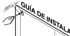
Atornille las piezas inferiores después de hacer coincidir todo el producto con los anclajes de plástico y acople completamente los tornillos superiores.
