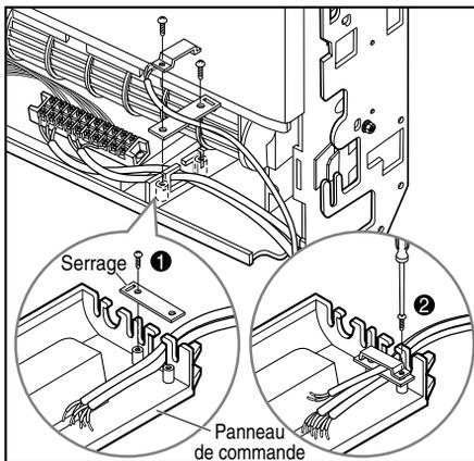
**Le cordon d'alimentation** branché sur l'unité intérieure doit être conforme aux spécifications suivantes: (Type H05VV-F(intérieur), homologué HAR ou SAA).
