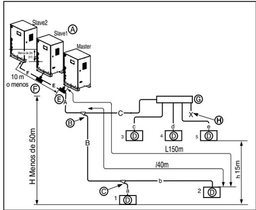
**No se podrá instalar un conducto de bifurcación después del conector**
