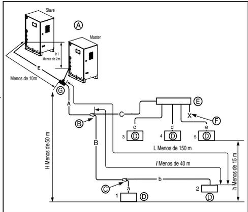
↳ **Longitud total del conducto de refrigerante = A + B + C + a + b + c + d + e ≤ 300 m**
