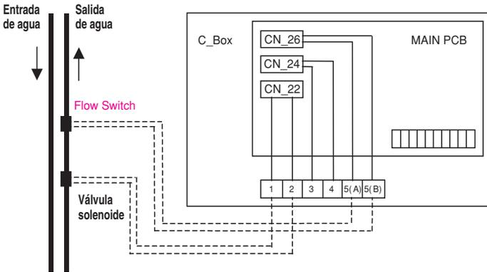
Ajuste el interruptor DIP según la fig.1 y active el suministro eléctrico cuando controle de forma individual la válvula solenoide de agua.
