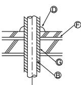
**Eje del conducto de techo**
