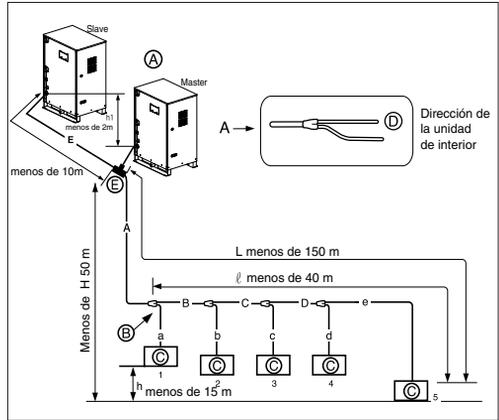
↳ Longitud total del conducto =  $A + B + C + D + a + b + c + d + e \leq 300$  m
