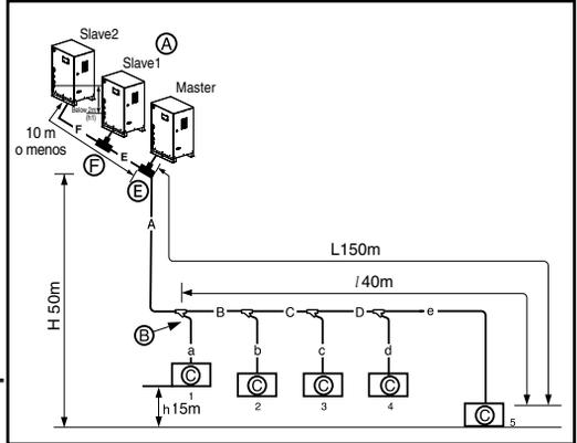
⇒ **Unidad de exterior esclava - Conducto de bifurcación (F): Diámetro del conducto entre las unidades de exterior (E)**
