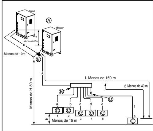
**⇒ Conducto de bifurcación Ⓔ ~ parte de la bifurcación con colector (B): Diámetro del conducto principal (A)**
