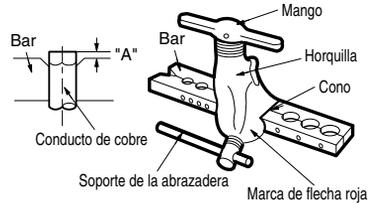
Sujete firmemente el tubo de cobre en una barra (o troquel) segun las dimensiones indicadas en la tabla a continuacion.
