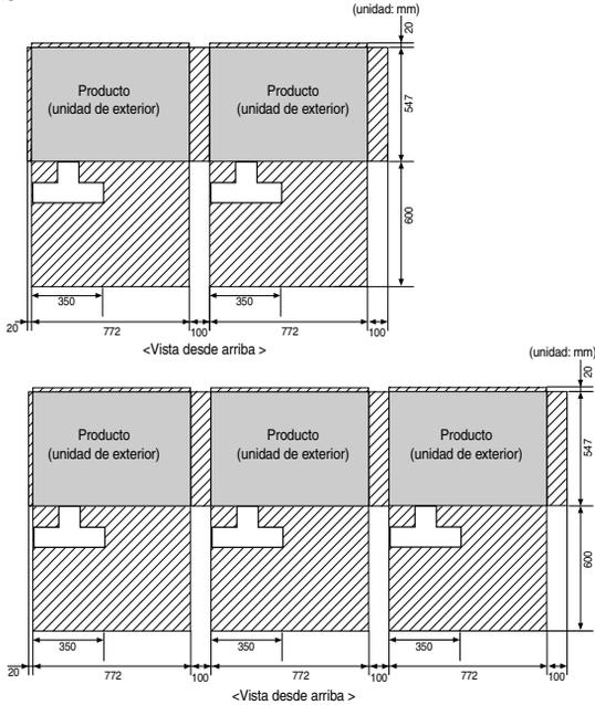
\* En caso de que el conducto del agua pase por el lateral del producto, asegúrese de que haya espacio de servicio suficiente entre el conducto del agua y el lateral del producto.
