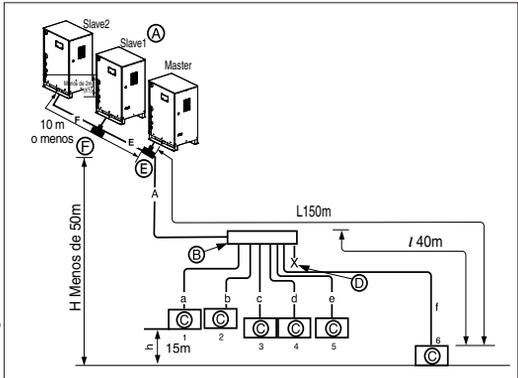
**No se podrá instalar un conducto de bifurcación después del conector**
