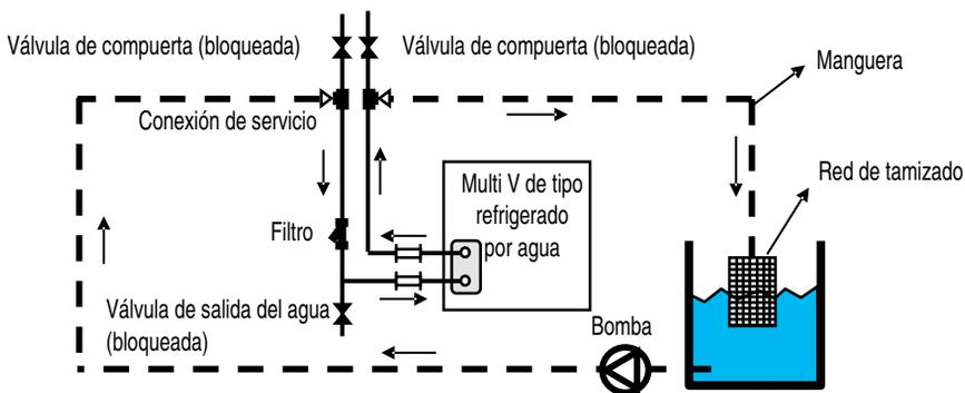
[Limpieza del intercambiador de calor de paneles]
