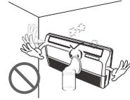
**S'il y a une fuite de gaz inflammable, fermez le robinet à gaz et ouvrez une fenêtre pour ventiler la pièce avant de mettre en marche le climatiseur.**
