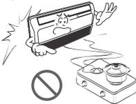
**Si le climatiseur dégage des sons, des odeurs ou de la fumée, mettez le disjoncteur sur la position arrêt (off) ou débranchez le cordon d'alimentation.**
