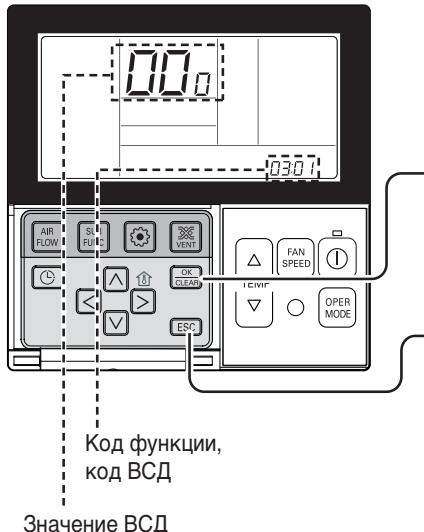
**6** Снова выберите режим вентилятора ВСД с помощью кнопки и настройте значение ВСД, как в пунктах №. 4 и 5, которые соответствует каждому режиму потока воздуха
