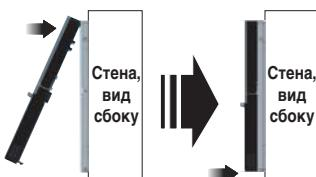
Снимайте пульт дистанционного управления с панели, как показано на следующем рисунке. Сначала вставьте в нижнее съемное отверстие отвертку и, вращая ее по часовой стрелке, снимите пульт дистанционного управления.
