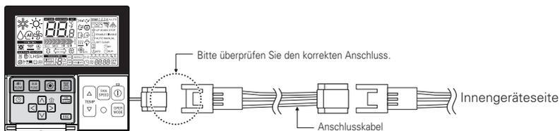
5. Bei einem Abstand zwischen Kabel-Fernbedienung und Innengerät von mehr als 10 m sollte ein Verlängerungskabel verwendet werden.
