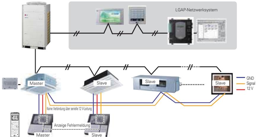
\* Es können bis zu N Innengeräte über M Kabel-Fernbedienungen bedient werden. ( $M+N \leq 17$  Geräte)
