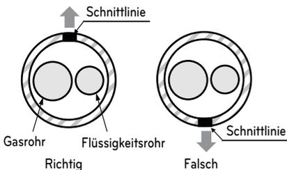
\* Schnittlinie der Rohrleitung muss nach oben zeigen.
