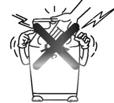
No instale el lavarropas en el aire libre y en un lugar húmedo como el baño. Hay peligro de descarga eléctrica, incendio, avería y deformación.
