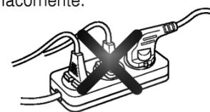
No modifique el cable eléctrico ni ponga cosas pesadas arriba. Hay peligro de incendio y descarga eléctrica por el deterioro del cable eléctrico.
