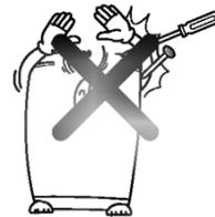
Instale en el piso suficientemente resistente y horizontal. Es la causa del sonido y vibración. Véa la página 32.
