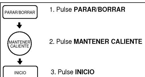
Cuando el ciclo de la cocción haya terminado, el horno accionará a "MANTENER CALIENTE" para mantener calientes los alimentos y la potencia se mostrará en el desplegado. El control para cocción cambia a la potencia 1.
