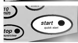
Podczas podgrzewania za pomocą funkcji szybkiego startu można wydłużyć czas aż do 99 minut 59 sekund poprzez wielokrotne naciśnięcie przycisku **START**.
