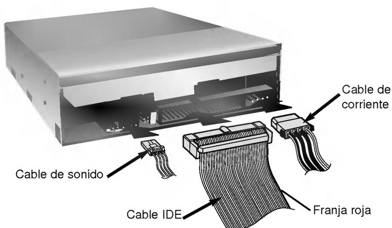
**NOTA:** La franja roja del cable IDE debe concordar con el pin 1 del conector IDE de la unidad DVD-ROM.
