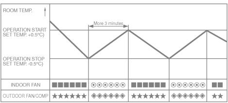
■: SETTING FAN SPEED : LOW COOL OPERATION : COMP ON : COMP OFF
