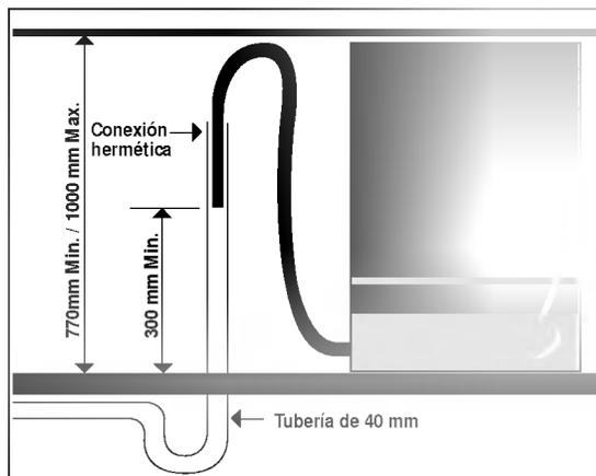
Fig. B Conexión de desagüe – tubo vertical.
