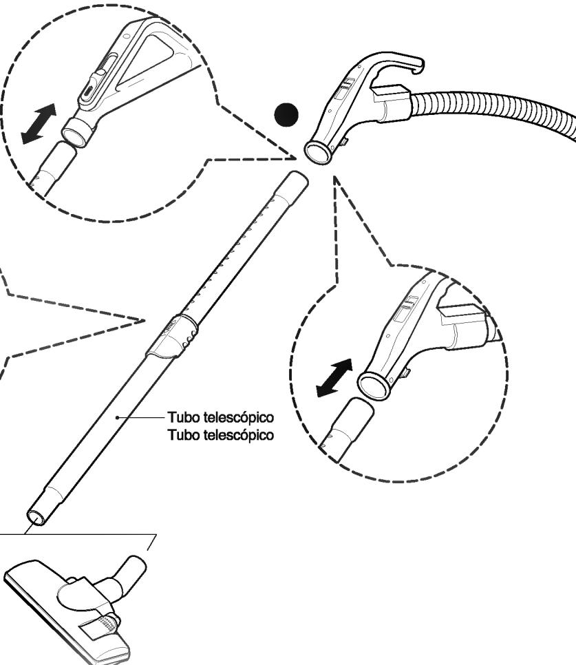
Introduzca el tubo ajustable en la salida de la boquilla.
