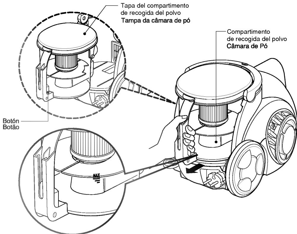
El compartimento de recogida del polvo debe vaciarse cuando el polvo llegue al indicador MAX del tanque del polvo.
