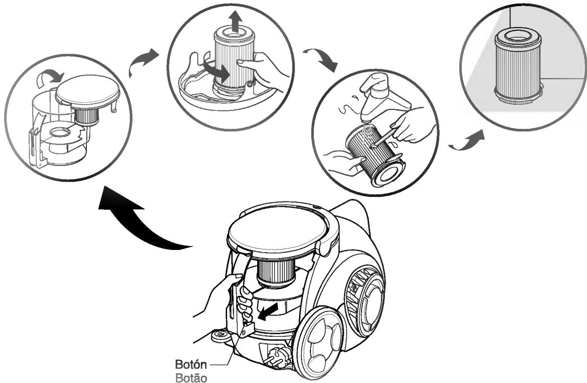
El filtro reutilizable del motor está situado bajo la tapa del compartimento de recogida del polvo y se puede utilizar permanentemente.
