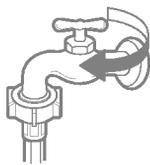
2 Débrancher le tuyau d'arrivée d'eau
