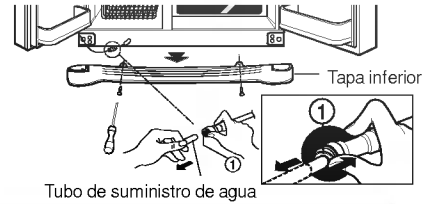
Tubo de suministro de agua
