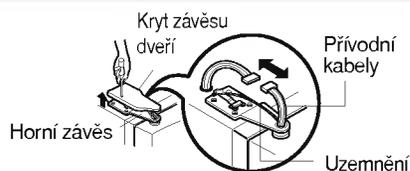
2) Otáčením proti směru hodinových ručiček odstraňte úchyt závěsu (①) a zvedněte horní závěs (②).
