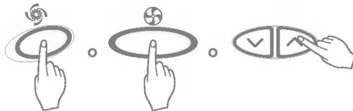
❑ Durante la función de frío en chorro en cualquier momento, el A/C empieza a enfriar el aire frío a una velocidad extremadamente elevada durante 30 minutos, fijando de este modo la temperatura de la habitación automáticamente a 18 °C. Esto se usa especialmente para enfriar la temperatura de la habitación en el espacio de tiempo más corto posible en un verano caluroso.
