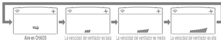
**El aire en CHAOS** ahorra consumo de energía y evita el sobreenfriamiento. La velocidad del ventilador cambia automáticamente de media a baja o viceversa, dependiendo de la temperatura ambiente.
