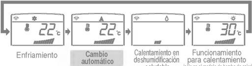
Enfriamiento      Cambio automático      Calentamiento en deshumidificación saludable      Funcionamiento para calentamiento (sólo en el modelo de bomba de calor)
