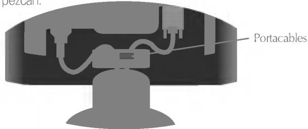
5. Conecte la **cubierta del soporte** y baje la **puerta corrediza** a continuación.
