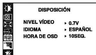
**NIVEL VÍDEO** Este elemento se utiliza para seleccionar el nivel de la señal de entrada del monitor. El nivel normal utilizado en la mayoría de PC es 0,7V. Si de repente la pantalla se pone en blanco o se vuelve borrosa, seleccione 1,0V e inténtelo de nuevo.
