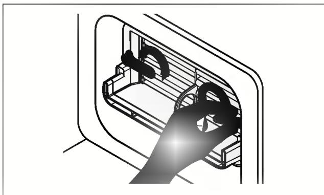
4. Ziehen Sie den Luftkühler mit Hilfe eines Fingers, den Sie in die Öffnung an der unteren Vorderseite stecken, heraus. (Behandeln Sie den Luftkühler nicht mit Gewalt!)
