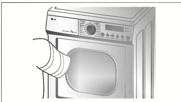
2. Drehen Sie die Lampenabdeckung mit einer Hand und unter leichtem Druck im Uhrzeigersinn.
