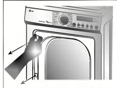
5. Schrauben Sie die beiden Scharniere ab.
