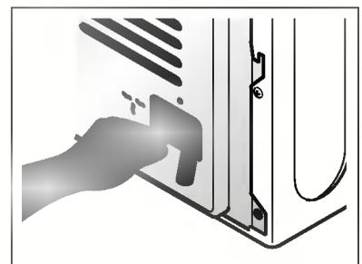
4. Verbinden Sie den Kondensat-Ableitungsschlauch mit der Anschlussgarnitur.
