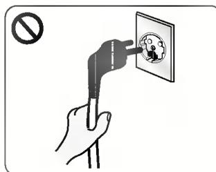
• Ziehen Sie den Netzstecker nur am Steckergriff und nicht am Kabel aus der Steckdose!
