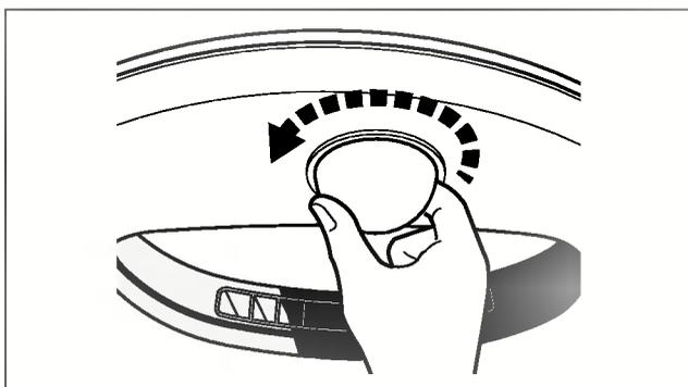
3. Entfernen Sie die Lampenabdeckung.
