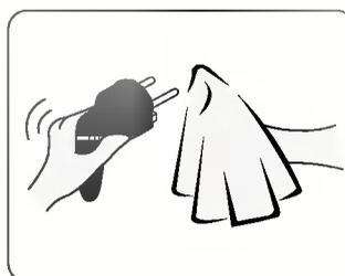
• Entfernen Sie Verunreinigungen und Spritzer vom Anschlusskabel und stecken Sie den Stecker fest in die Steckdose!
