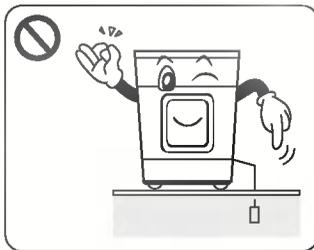
• Ihr Trockner ist für einen Anschlusswert von 230V geeignet. Bevor Sie das Netzkabel anschließen, vergewissern Sie sich, dass das Kabel geerdet ist und an eine Schutzkontaktsteckdose angeschlossen wird.
