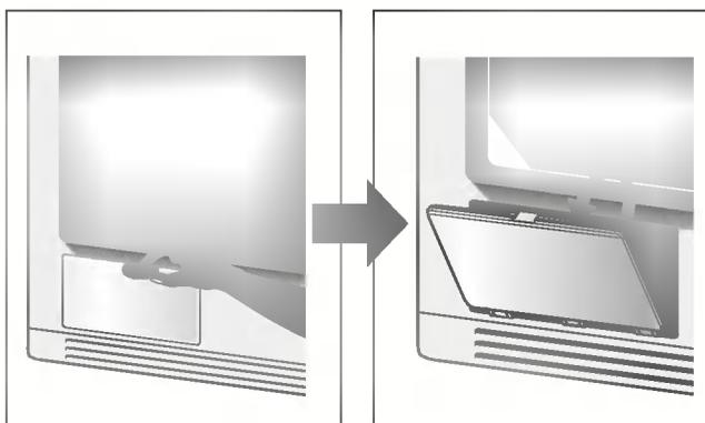
2. Öffnen Sie die Verschlussabdeckung durch Drehen des Verschlusshebels.
