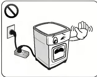
• Verwenden Sie keine Verlängerungskabel oder Mehrfachstecker, um das Netzkabel anzuschließen!
