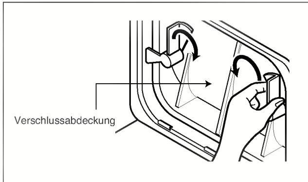
3. Lösen Sie beide Arretierhebel durch Drehen zueinander.
