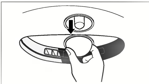
4. Entfernen Sie nun die Glühlampe, indem Sie sie entgegen dem Uhrzeigersinn herausdrehen. Geben Sie acht, dass die Glühlampe nicht herunterfällt.
