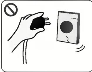
• Verwenden Sie keine defekten Anschlusskabel, Stecker und Steckdosen!
