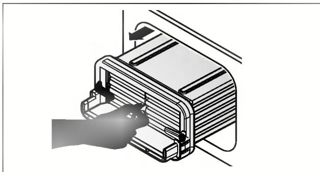
5. Reinigen Sie den Luftkühler gründlich unter fließendem Wasser.
