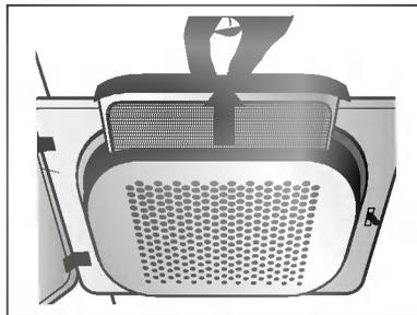
3. Reinigen Sie den Filter mit einem Staubsauger oder halten Sie ihn unter fließendem Wasser.
