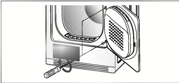
2. Entfernen Sie die Türverschluss-Abdeckung.
