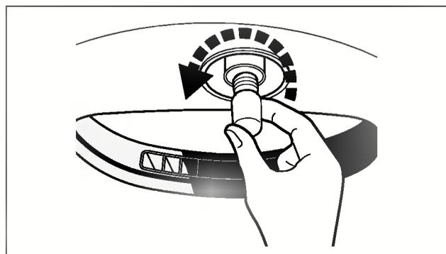
5. Schrauben Sie eine neue Glühlampe in entgegengesetzter Richtung wie zuvor ein.
