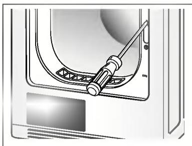
3. Entfernen Sie den Türverschluss und setzen Sie ihn an die durch eine Türverschluss-Abdeckung vorgesehene Stelle wieder ein.
