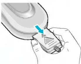
Rút bộ sạc ra khỏi điện thoại bằng cách nhấn hai nút ở cạnh đầu cắm như hướng dẫn trong hình.
