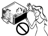
Si entra agua en el producto, apague el interruptor de la carcasa principal del aparato. Póngase en contacto con el centro de servicio después de haber sacado el enchufe del tomacorriente.
