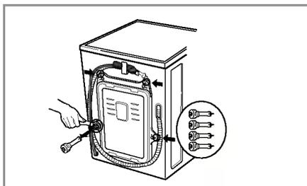
3. Enlever les 4 vis ainsi que les bondes en caoutchouc en tordant légèrement la bonde. Garder les 4 vis et la clé pour une utilisation future.
