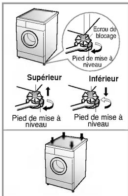
2. Si le sol est inégal, régler les pieds de mise à niveau (ne pas insérer de pièces de bois, etc ... sous les pieds). S'assurer que les quatre pieds sont stables et reposent sur le sol et vérifier ensuite que l'appareil est parfaitement de niveau (utiliser un niveau à bulle d'air).
