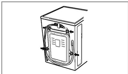
1. Les 4 vis spéciales sont serrées pour prévenir tous dommages internes pendant le transport. Avant de faire fonctionner la machine à laver, enlever les vis ainsi que les bondes en caoutchouc.
