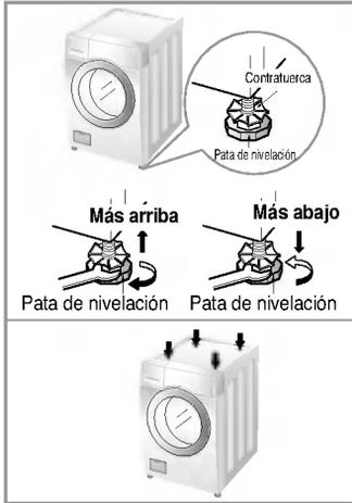
1. La nivelación correcta de una lavadora impide el ruido y la vibración excesivos.
