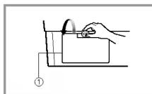
2. Desconecte el tapón de drenaje (②) dejando que el agua fluya hacia fuera. En este momento utilice un recipiente para impedir que el agua caiga al suelo. Si ya no sale agua, gire el filtro de la bomba (③) a la izquierda hasta abrirlo totalmente.
