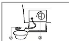
3. Saque cualquier material extraño del filtro de la bomba (③). Después de la limpieza, gire el filtro de la bomba (③) en el sentido de las agujas del reloj e inserte el tapón de drenaje (②) en su lugar original. Cierre el tapón de la cubierta inferior.
