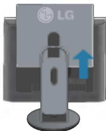
2. Coloque el monitor sobre un cojín o un trapo suave con la parte frontal hacia abajo.
