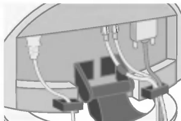
5. Cuando haya dispuesto los cables correctamente, inserte la cubierta posterior en la ranura.
