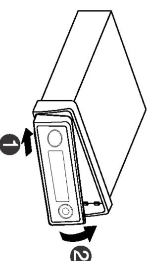
Poravnajte lijevu stranu ploče s graničnikom, a zatim gurnite desnu stranu ili ploču u uređaj dok se ne začuje klik.
