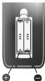
Quite la tapa del compartimento para las pilas por el reverso del control remoto e inserte dos pilas tamaño AAA ⊕ y ⊖ alineadas correctamente.
