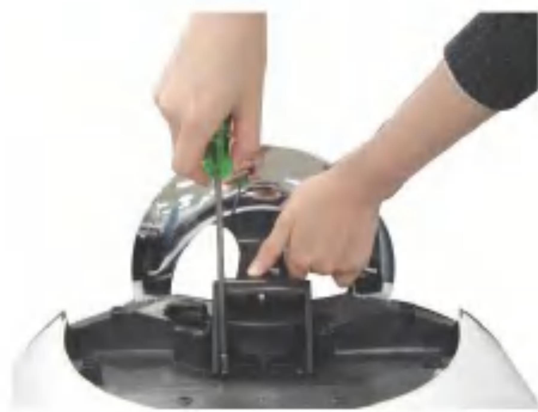
2. С помощью отвертки отсоедините основание подставки, как показано на рисунке.
