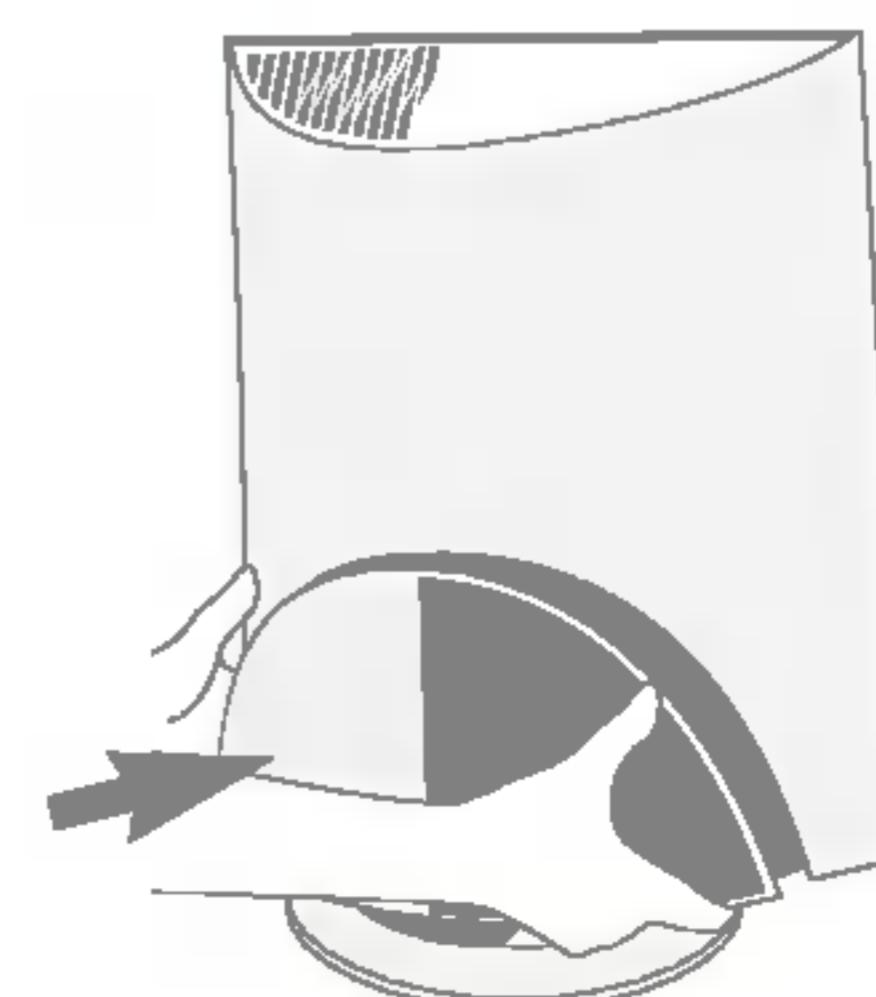
5. Закрепив таким образом кабели, установите заднюю крышку монитора в паз.
