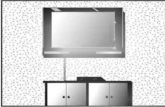
Afin de permettre une aération suffisante, l'espace minimum requis est de 10 cm de chaque côté et derrière le mur. Vous trouverez les instructions détaillées de l'installation chez votre revendeur ; reportez-vous également au Guide de configuration et d'installation de l'interface de montage au mur.
