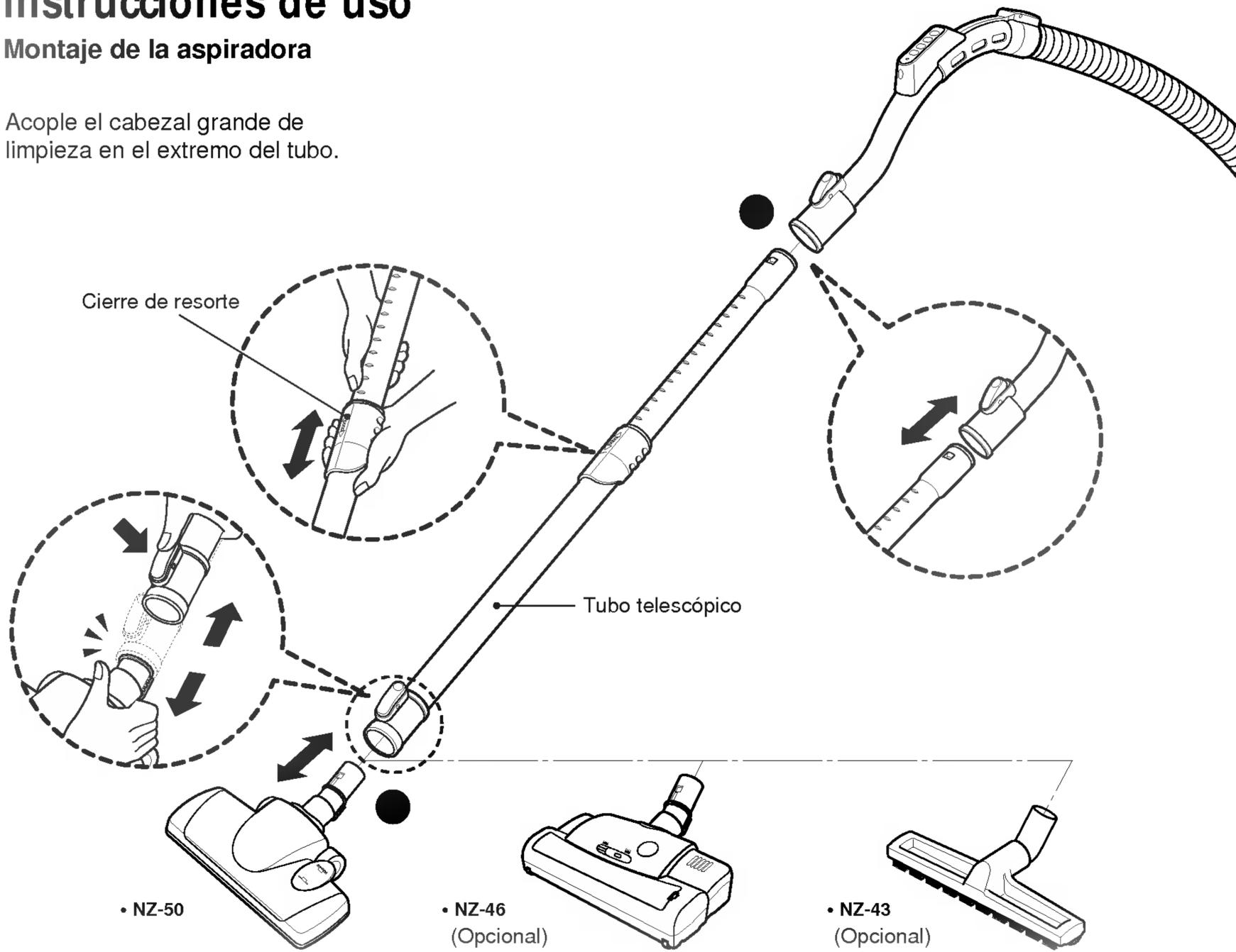
Empuje el cabezal sobre el tubo telescópico
