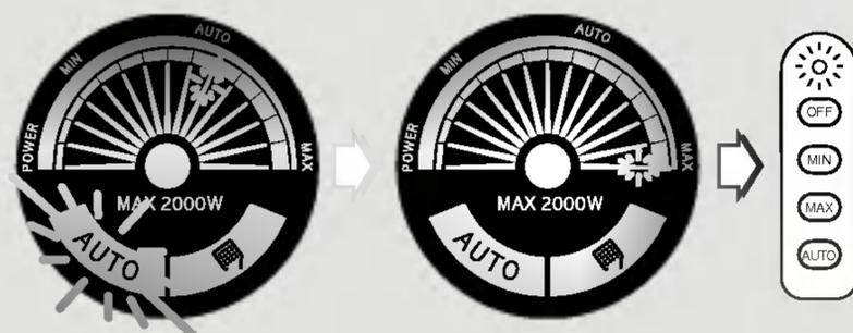
Cuando funcione en modo Auto, el LED parpadeará si el sensor de polvo detectara polvo. Tras esa operación, el modo cambiará a modo MAX.
