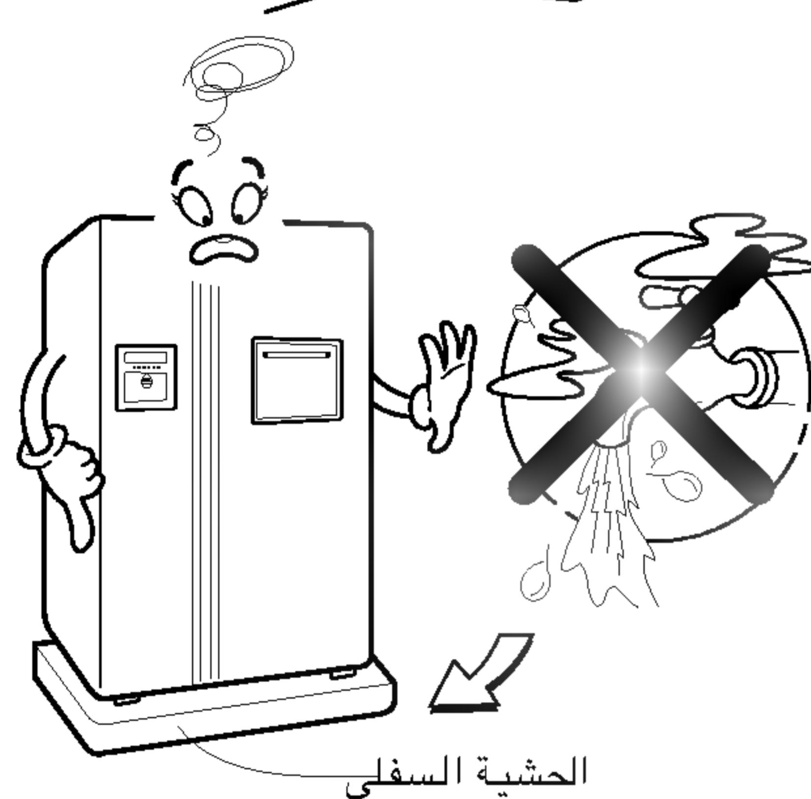
اختر مكاناً بحيث أنبوب إمداد الماء يمكن توصيله بسهولة إلى صانع الثلج الآوتوماتيكي وموزع الماء. في المكان المبلل أو القريب من الماء، قد يحدث الصدأ في الثلاجة أو قد تتسرّب الكهرباء.
