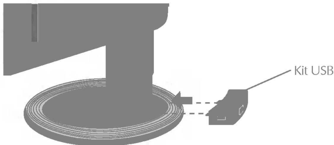
1. Connectez le port USB ascendant du moniteur sur le port descendant d'un PC compatible USB ou sur un autre concentrateur à l'aide du câble. (L'ordinateur doit disposer d'un port USB)
