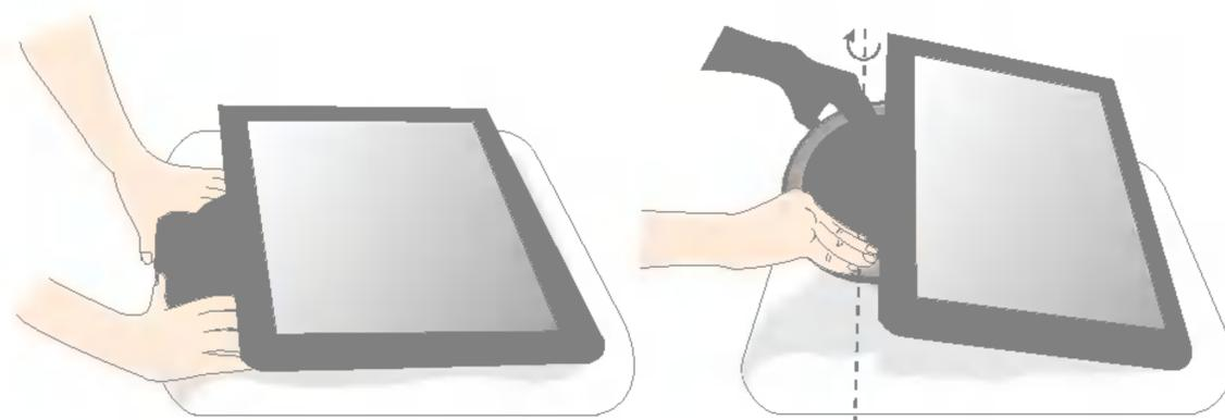
2. Posicione o monitor com sua parte frontal voltada para baixo e, em seguida, expanda totalmente a base de sustentação em 90 graus. Não use de muita força para expandir a base em 90 graus, caso contrário você poderá danificar o monitor.
