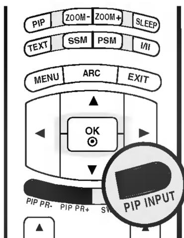
■ Pulse los botones **PIP INPUT** para seleccionar una fuente de entrada para la imagen secundaria.
