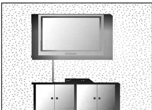
Para una ventilación adecuada, deje un hueco de 4 pulgadas a cada lado de la unidad y entre la unidad y la pared. Si desea obtener instrucciones de instalación detalladas facilitadas por el distribuidor, consulte el manual de configuración e instalación en pared opcional con abrazaderas.
