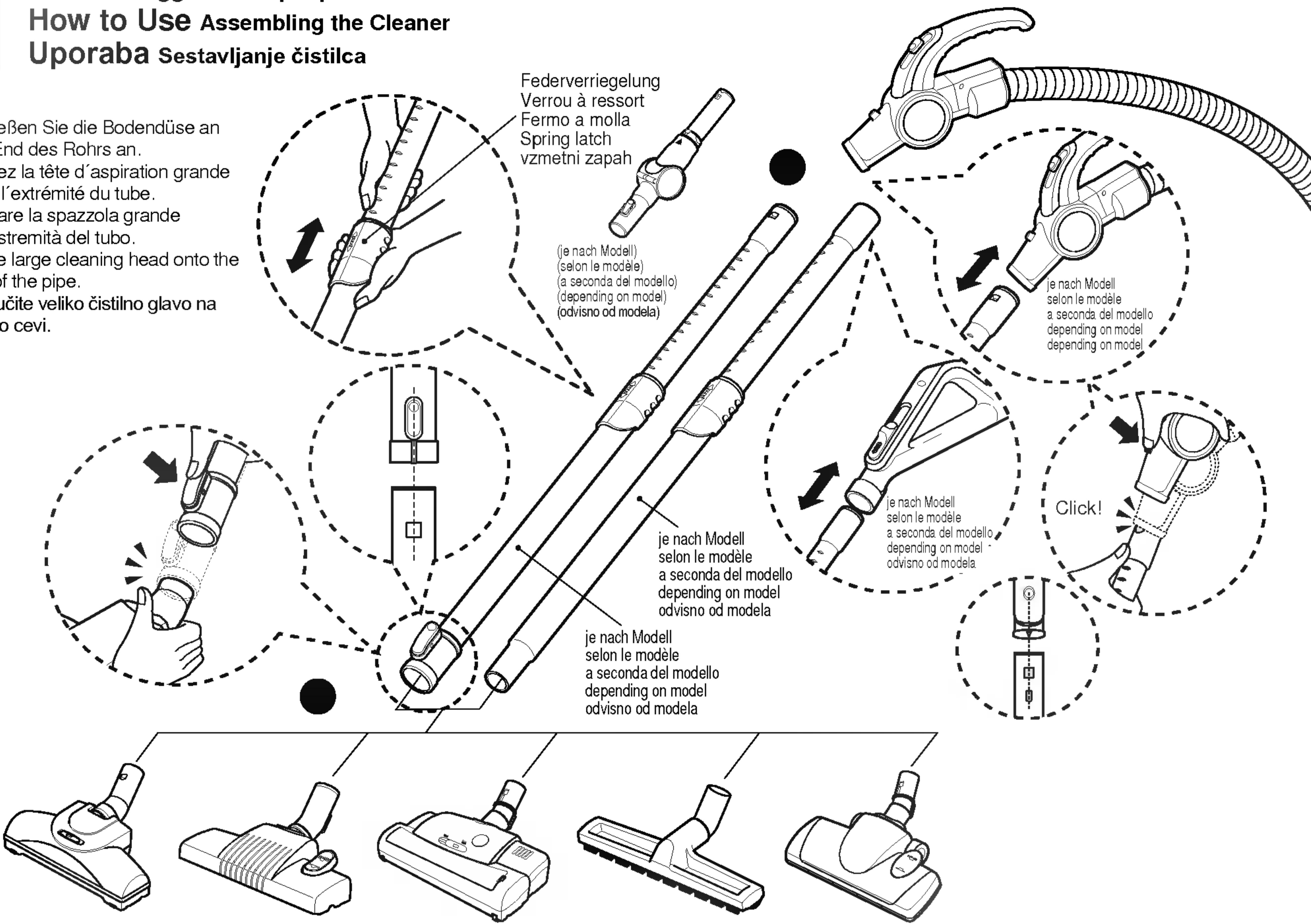
Schieben Sie die Bodendüse auf das Teleskoprohr.
