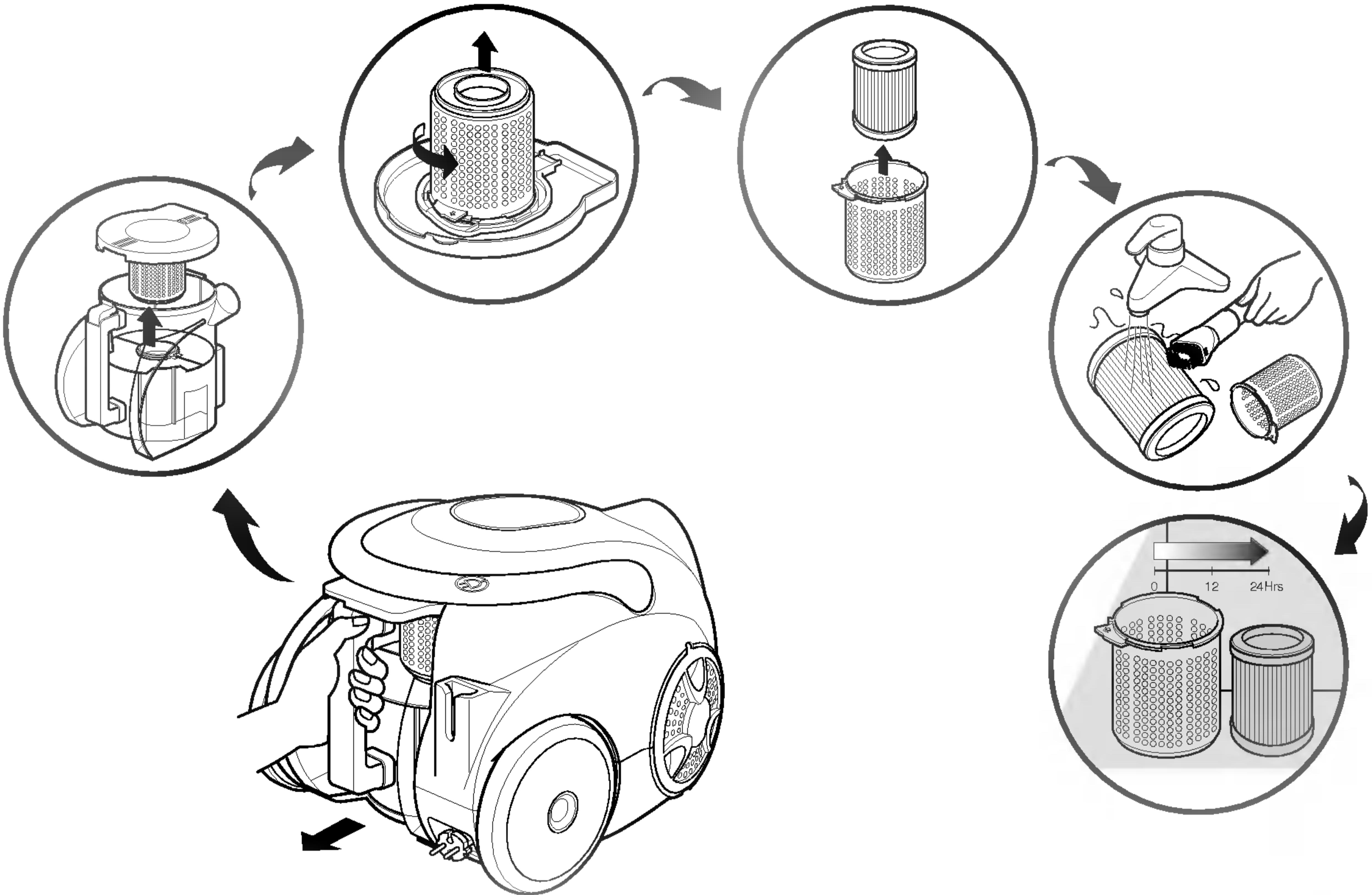
Die dauerhaft verwendbaren Filter befinden sich unter der Staubkammer-Abdeckung.
