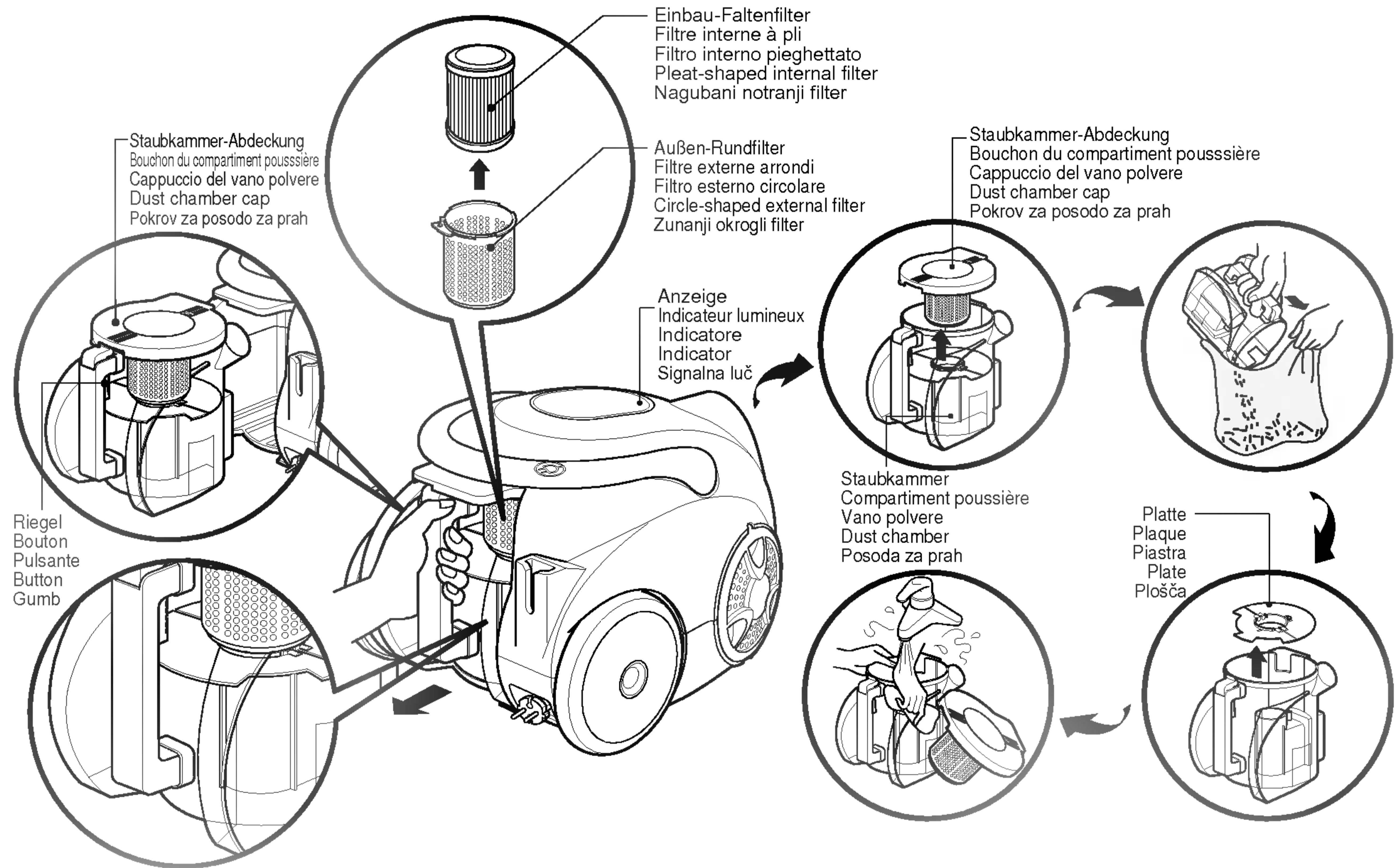
Der Staubbehälter muss entleert werden, sobald die Anzeige rot leuchtet. Beim Einsaugen von feinem Staub könnte die Saugleistung abnehmen. Reinigen Sie in diesem Fall den Filter.
