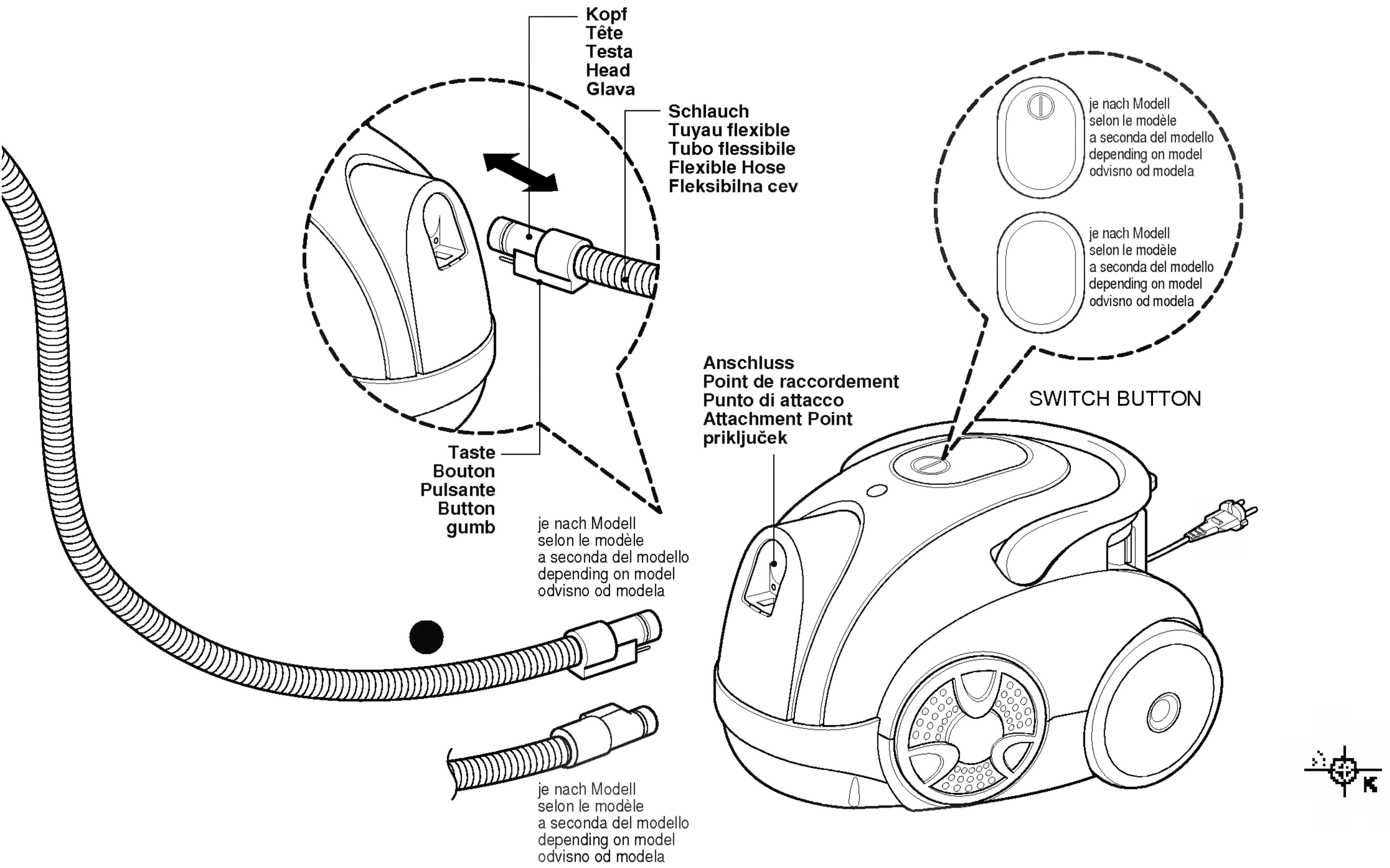
Führen Sie das Ende des Schlauchkopfs in den Anschluss am Staubsauger ein.
