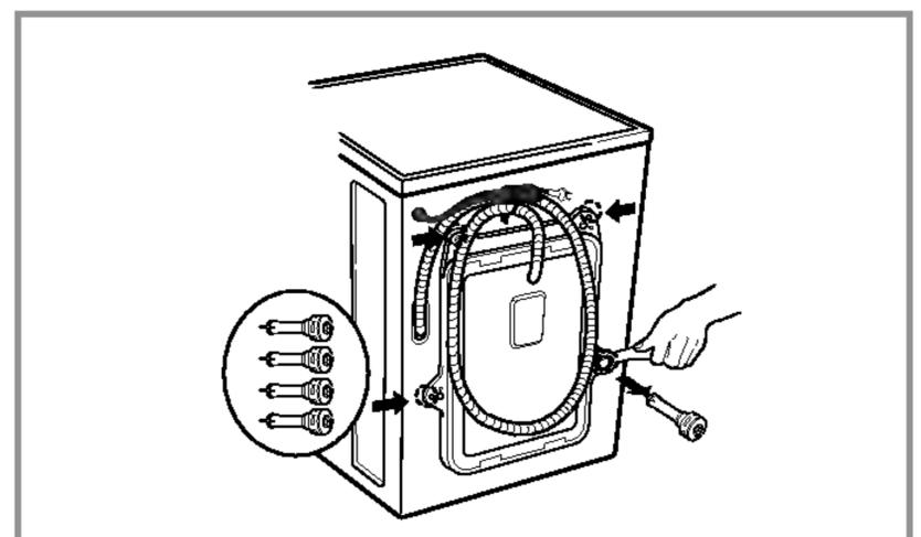
**1.** Para impedir los daños internos durante el transporte, los 4 tornillos especiales estan bloqueados. Antes de hacer funcionar la lavadora, quite los tornillos junto con los tapones de caucho.
