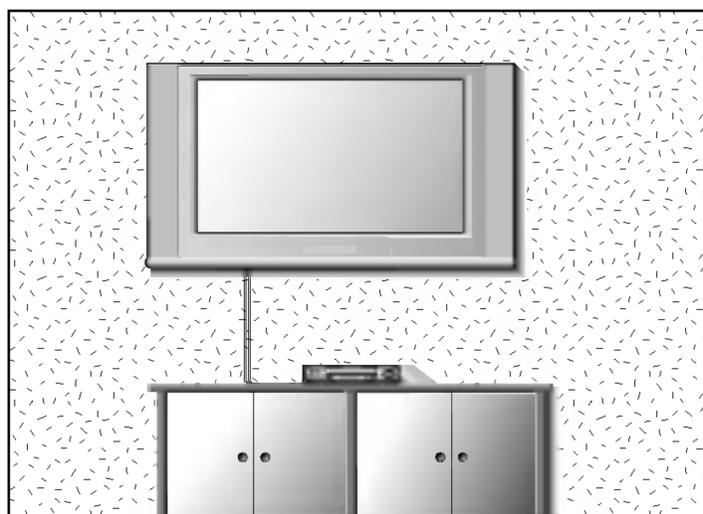
Para melhor ventilação, permita uma distância de 10cm de cada lado, e da parede. As instruções detalhadas você pode obter no guia de instalação do seu Suporte de parede.
