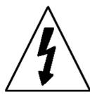
Dieser Blitz mit Pfeil in einem gleichseitigen Dreieck weist den Benutzer auf das Vorhandensein einer unisolierten, gefährlichen Spannung im Gehäuse hin, die stark genug sein kann, einer Person einen gefährlichen elektrischen Schlag zu versetzen.
