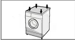
1. Pour réduire les vibrations et les bruits excessifs, installer la machine sur un sol stable et à niveau, de préférence dans un coin de la pièce.
