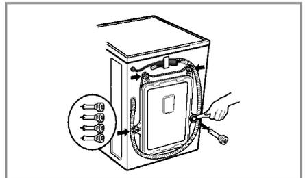
1. Les 4 vis spéciales sont serrées pour prévenir tous dommages internes pendant le transport. Avant de faire fonctionner la machine à laver, enlever les vis ainsi que les rondelles en caoutchouc.
