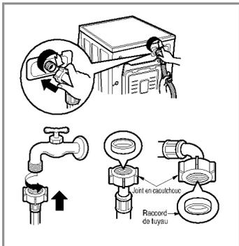
▶ La pression d'alimentation d'eau doit être comprise entre 30kPa et 1000kPa (0,3~10kgf/cm<sup>2</sup>).
