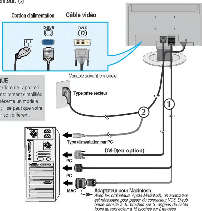
4. Appuyez sur le bouton
