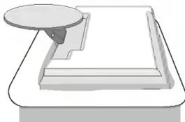
2. Maintenir le bouton de déverrouillage en position basse à l'intérieur du support et tirez solidement sur le support à deux mains.
