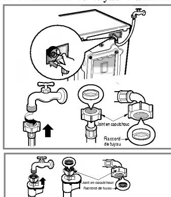
► La pression d'alimentation d'eau doit être comprise entre 30kPa et 1000kPa (0,3~10kgf/cm<sup>2</sup>).
