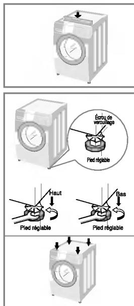
1. Pour réduire les vibrations et les bruits excessifs, installer la machine sur un sol stable et à niveau, de préférence dans un coin de la pièce.
