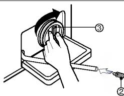
4. Verwijder al het vreemde materiaal uit de pompfilter (3). Draai, na reiniging de filterpomp (3) weer vast (naar rechts) en breng de afvoerplug (2) weer op haar plaats, sluit de plintdekselkap.
