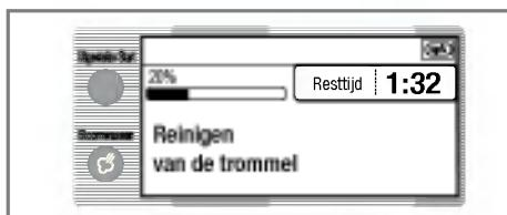
Het trommelreinigingsprogramma is een speciaal wasprogramma om de binnenkant van de wasmachine schoon te spoelen. Dit wasprogramma verbruikt meer water en draait sneller. Voer dit programma regelmatig uit.
