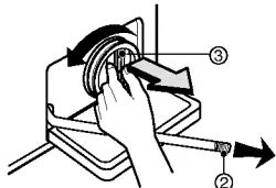
2. Trek de afvoerstop eruit (2), waardoor het water uit de filter loopt. Gebruik een kom om het water op te vangen. Als er geen water meer uitkomt, draai dan de pompfilter (3) naar links open.
