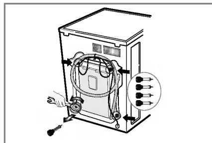
1. Om interne schade tijdens het transport te vermijden zijn de 4 speciale vergrendelingsbouten vastgeschroefd. Vooraleer de wasmachine in gebruik te nemen, moet u de bouten en de rubberen stoppen verwijderen.
