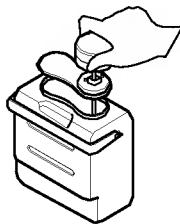
2 Očistite vanjsku i unutarnju površinu spremnika za vodu sredstvom za pranje posuđa i temeljno ga isperite tekućom vodom.
