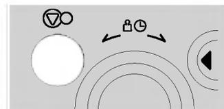
Presione y mantenga pulsado **STOP/ CLEAR** hasta que aparezca "L" en la pantalla de visualización y se oiga una señal acústica.
