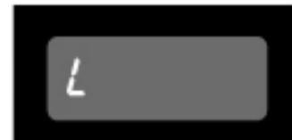
Para cancelar el **CIERRE A PRUEBA DE NIÑOS**, presione y mantenga pulsado **STOP/ CLEAR** hasta que desaparezca la "L", oirá señal acústica como indicación de la desactivación.
