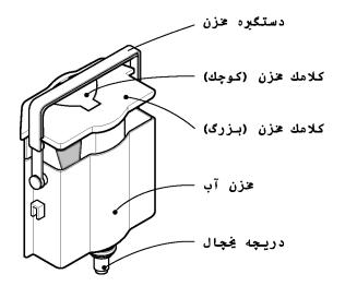
**نصب** لطفاً دریچه یخچال را پس از تنظیم صحیح آن با سوراخ در، نصب نمایید.
