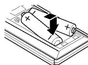
Retirez le couvercle de la pile qui se trouve à l'arrière de la télécommande, puis insérez deux piles R03 (taille AAA) et faites correspondre la polarité polarité en alignant correctement les pôles + et -.
