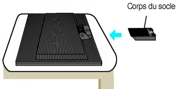
3. Insérez la Base du socle dans le Corps du socle dans la direction indiquée ci-dessous.
