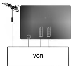
1. Подсоедините разъем типа Euro scart (скарт) видеоманитона к разьему Euro scart 1,2 телевизора.
