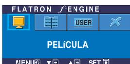
**PELICULA** Esta función le permite seleccionar fácilmente la mejor condición de imagen deseada optimizada para el entorno (iluminación ambiente, tipos de imágenes, etc.).
