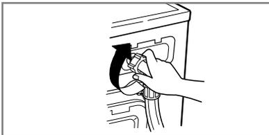
**4.** Den Wasserzulaufschlauch abschrauben.
