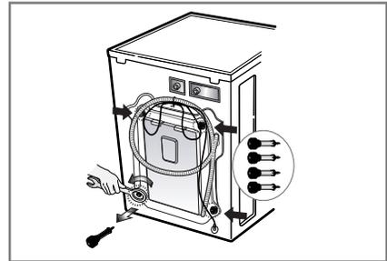
3. Die 4 Schrauben lösen und die Gummipropfen etwas drehen, um sie zusammen mit den Schrauben abzunehmen.
