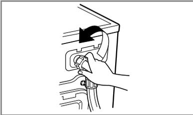
**2.** Den Wasserzulaufschlauch abschrauben.
