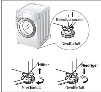
2. Bodenunebenheiten durch Drehen der Nivellierfüße ausgleichen (**keinesfalls Holz usw. unter die Füße schieben**). Sicherstellen, dass alle vier Füße den Boden berühren. Dann mit einer Wasserwaage sicherstellen, dass das Gerät waagrecht steht.
