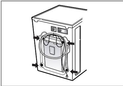
1. Das Gerät ist durch 4 Spezialschrauben gesichert, um Transportschäden zu verhindern.
